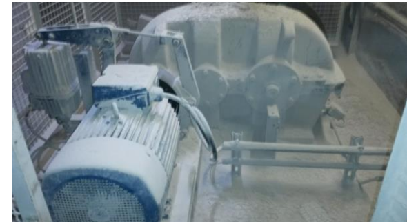
Abb. 2: Skipwinde an einem 200tato-Schachtofen mit Standard-Asynchronmotor 30 kW, 6-pol.
